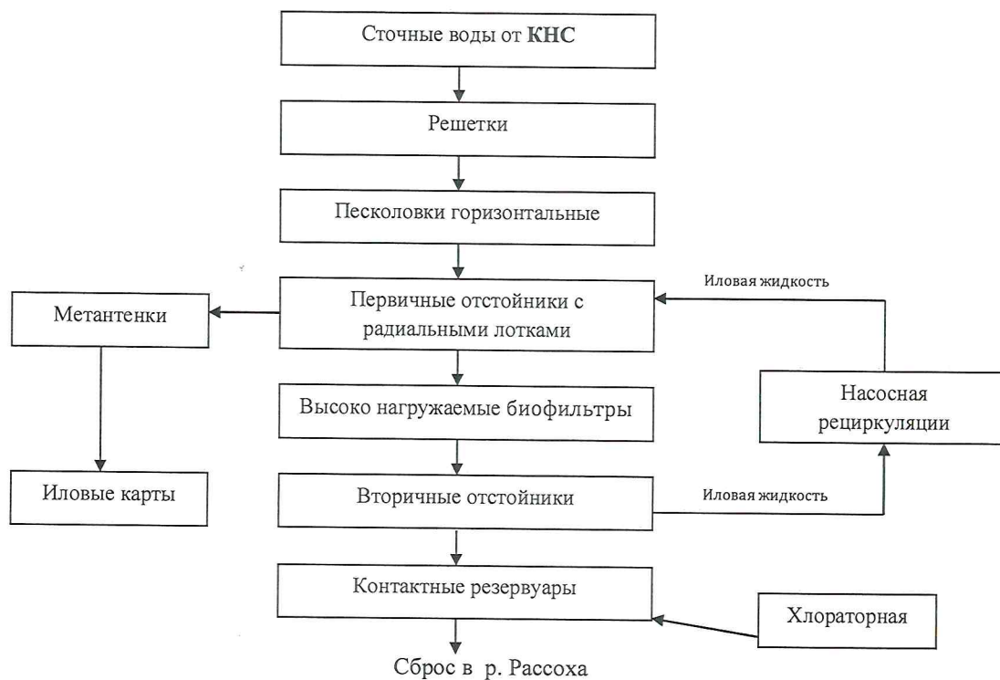
Рис. 1 — Схема работы городских очистных сооружений
